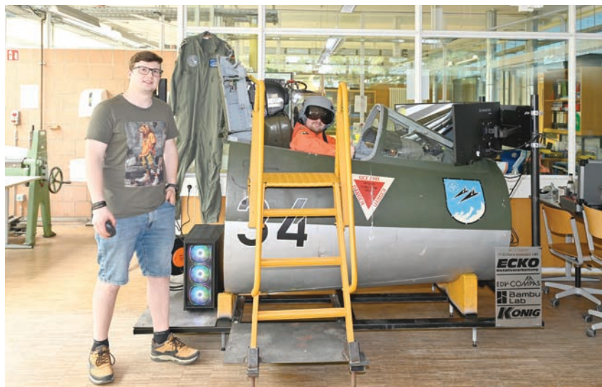
Hendrik Herbst und Janis Knappich (FTA24) bauten das Originalcockpit eines Lockheed F-104 Starfighters zum Flugsimulator um
