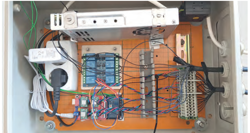
Blick in den Schaltkasten (oben die Pumpe, mittig die Relaiskarte, darunter der Arduino mit CNC Shield)
